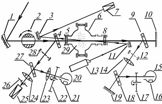
FIG. 1. Optical scheme: 1) spherical mirror; 2) shutter; 3) and 11) flat folding mirrors; 4), 9), 18) and 27) beam-splitting plates; 5) and 8) windows for collimated beam (CB); 6) measurement channel; 7) PMT-62; 10) and 19) absorbers; 12) and 28) wire-gauze bolometers; 13) LGN-302 laser; 14), 23) and 24) lenses (CB); 15) and 20) integrating spheres; 16) and 21) MG-30A pyroelectric receivers; 17) and 22) modulators; 25) calorimeter; 26) diaphragm; 29) dispersed medium.
