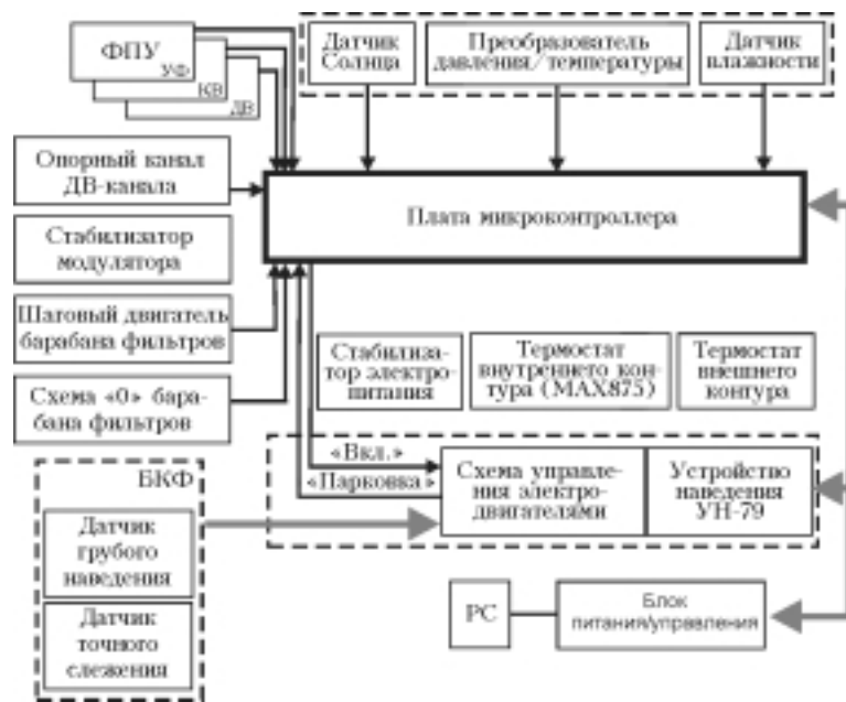
Рис. 3. Электронная блок-схема SP-6
