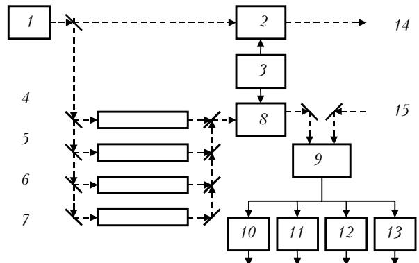
Функциональная схема когерентного ЛЧМ-лидара с хранением фазы опорного излучения: 1 – оптический квантовый генератор; 2, 8 – оптические модуляторы; 3 – генератор ЛЧМ-напряжения; 4–7 – линии задержки опорного излучения на основе оптического волокна; 9 – фотоприемник в режиме фотосмещения; 10–13 – фильтры разностных (дальномерных) частот; 14 – зондирующее излучение; 15 – сигнал обратного рассеяния; —— оптический сигнал; —— электрический сигнал
