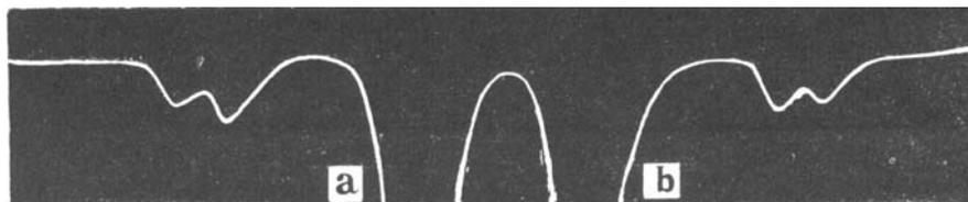
Рис. 8. Эффект корреляции временной формы сигналов стимулированного фотонного эха в рубине [35]: *a*– объектный импульс; *b*– эхоимпульс
