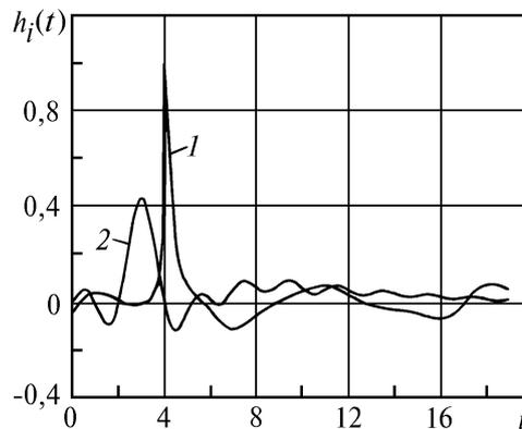
Рис. 2. Функция отклика БТФ-ОВЗ для зашумленного сигнала без (2) и со сглаживанием (1)
