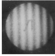
Рис. 6. Интерференционная картина, локализуемая в плоскости формирования изображения зрачка положительной линзы
