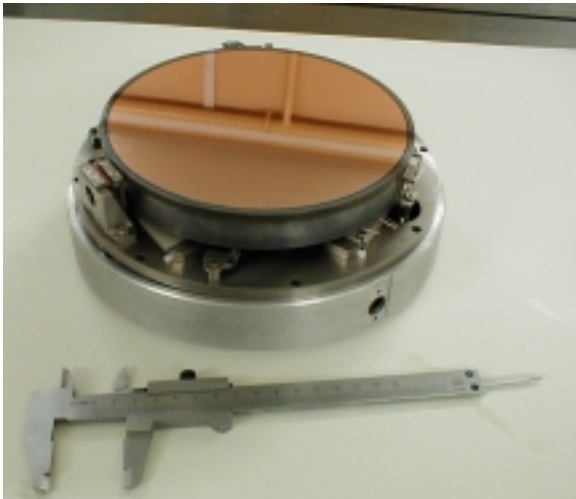
Рис. 8. Биморфное зеркало для имитации искажений волнового фронта
