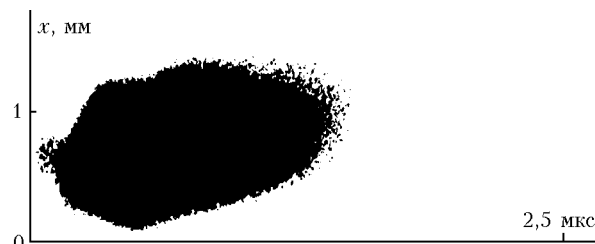
Рис. 4. Щелевая развертка собственного свечения плазменного факела, генерируемого лазерным излучением малой длительности
