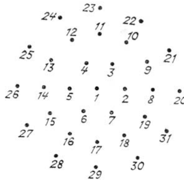
Расположение приводов в пластинчатых гибких зеркалах
