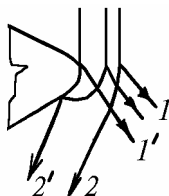
Рис. 4. Схема образования краевого света в случае тонкого экрана
