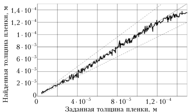
Рис. 2. Зависимость найденного значения толщины пленки от действительного значения толщины для усредненных результатов по серии из 30 измерений
