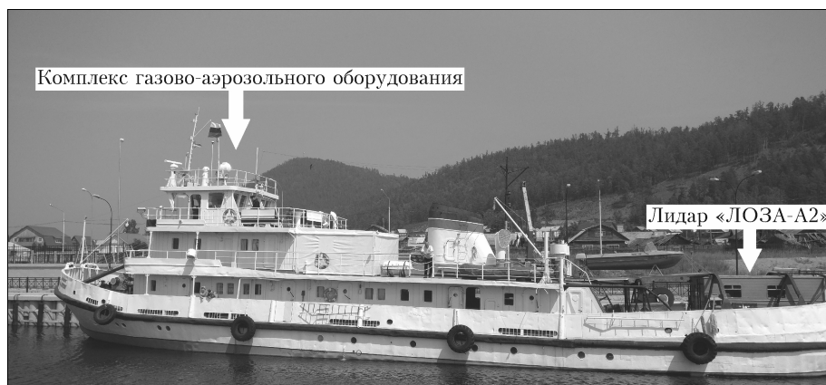
Рис. 1. НИС «Академик В.А. Коптюг» и расположение измерительного оборудования
