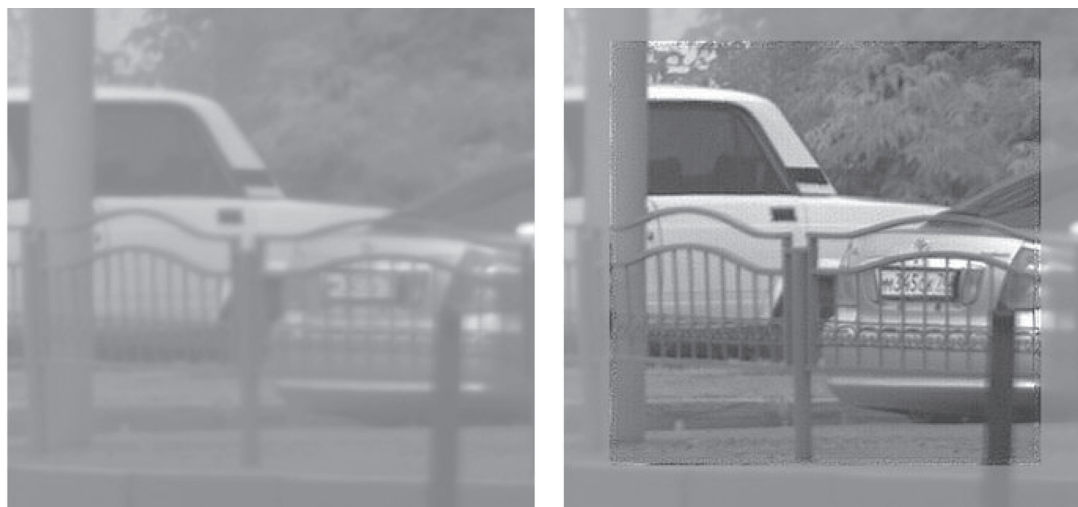
Рис. 4. Пример размытого атмосферой реального изображения из серии кадров, полученных на дистанции 2 км (слева), и результат восстановления ROI методом обратной фильтрации в реальном времени (справа)
