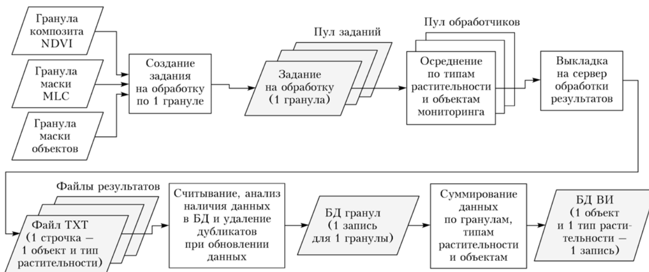
Рис. 3. Алгоритм расчета интегральных значений NDVI
