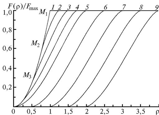
Рис. 2. Параметрическое семейство зависимостей геометрического фактора  $F(\rho)/F_{\max}$ ,  $\rho = z\gamma_\pi/R_\pi$  при вариациях отношения  $\eta = d/R_\pi$ ; кривые 1–9:  $\eta = 0; 0,25; 0,5; 0,75; 1,0; 1,5; 2,0; 2,5; 3,0$
