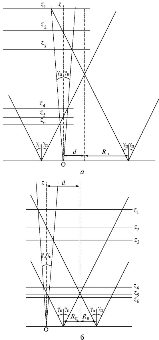
Рис. 1. Геометрическая схема лидарного зондирования:  $a - d < R_n$ ;  $b - d > R_n$
