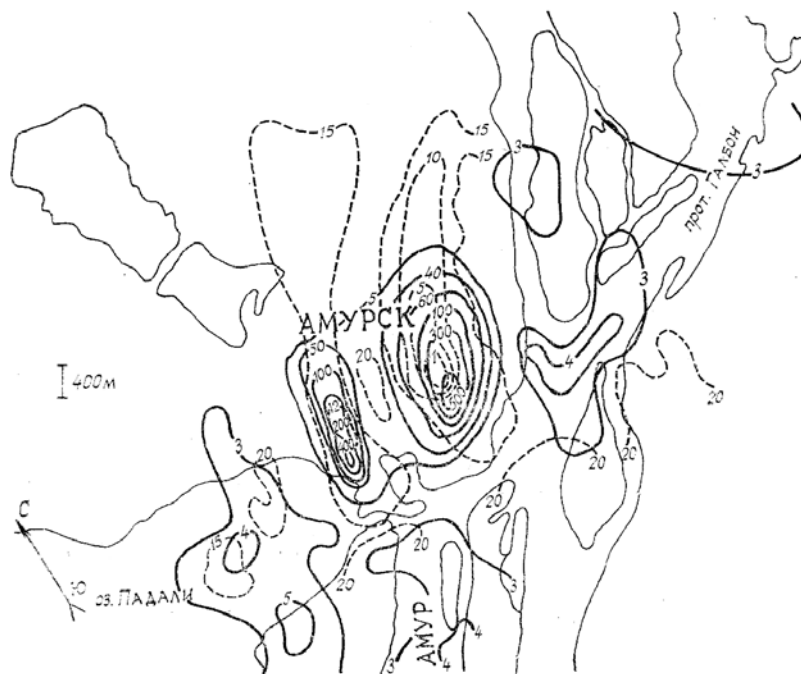
Рис. 4. Горизонтальное распределение счетной концентрации аэрозоля (сплошная) и озона (штриховая кривая) на высоте 400 м над г. Амурском
