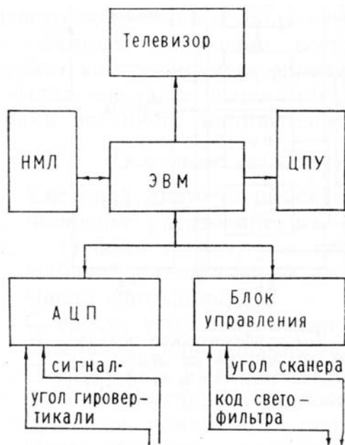
Рис. 4. Функциональная схема цифрового блока обработки и управления
