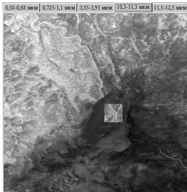
Рис. 5в. Пример восстановления экранированного участка изображения в 4-м и 5-м каналах методом регрессионного прогнозирования
