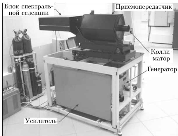
Рис. 7. Общий вид лидарного обнаружителя: длина × ширина × высота = 1600 × 1200 × 1600 мм
