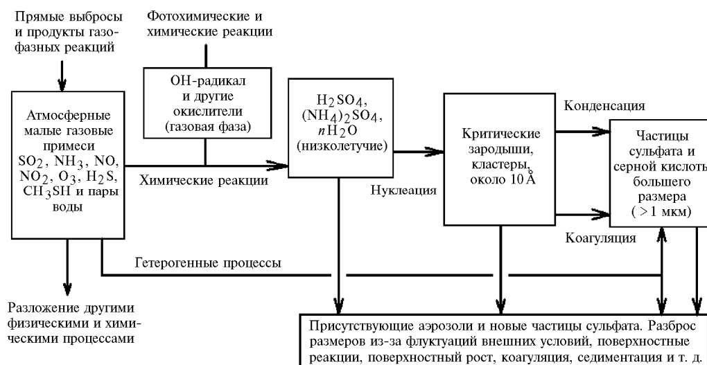
Рис. 1. Схема преобразования газ – частица (химические и физические трансформации \text{SO}_2 в сульфат)
