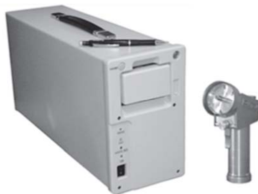
Рис. 2. Экспрессный ГХ ЭХО-В-ИДПС (слева) с вихревым пробоотборным устройством (справа)
