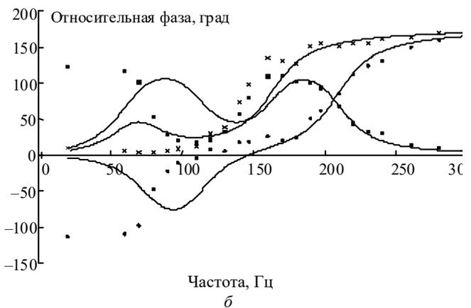
Рис. 11. Частотные характеристики РГ и ДРГ с двумя капиллярами при измерениях в режиме прокачки. Обозначения соответствуют рис. 7. Эквивалентная схема приведена на рис. 4, г
