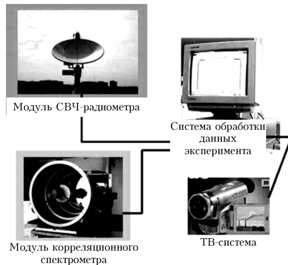
Рис. 1. Схема макета ДАН-2 для регистрации эмиссии и поглощения оптического и СВЧ-излучений газовых аномалий в атмосфере
