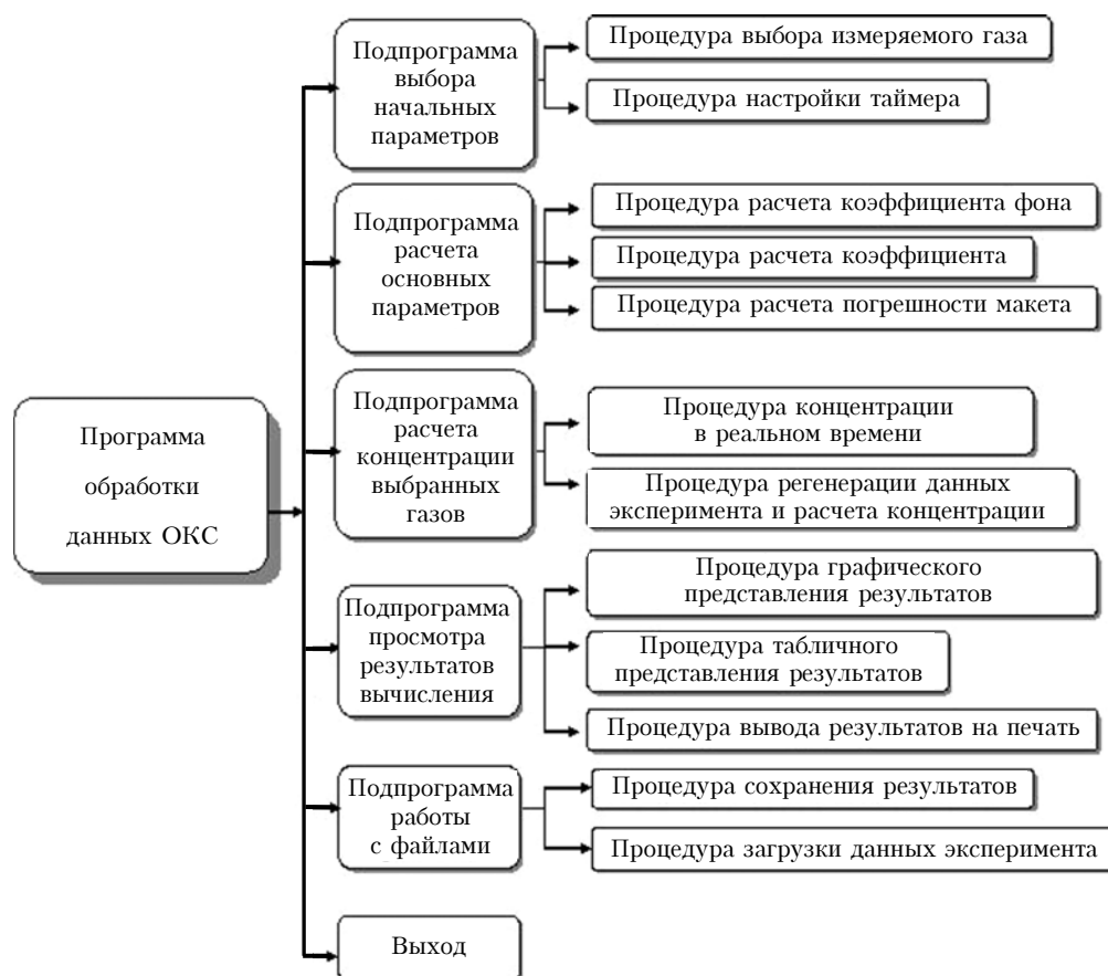
Рис. 5. Структурная схема программы обработки данных оптического корреляционного спектрофотометра
