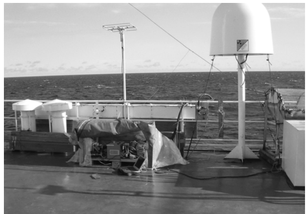
Рис. 5. Экспедиция на НИС «Профессор Штокман» по Белому морю. Нефелометр располагается в специально собранном укрытии (в центре фотографии), защищающем от дождя, ветра и брызг во время шторма
