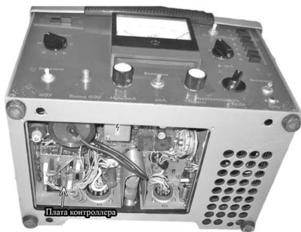
Рис. 3. Нефелометр ФАН-А. Положение платы контроллера внутри корпуса нефелометра
