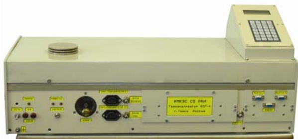
Рис. 2. Внешний вид газоанализатора ДОГ-4 для контроля концентрации выбросов NO и SO 2
