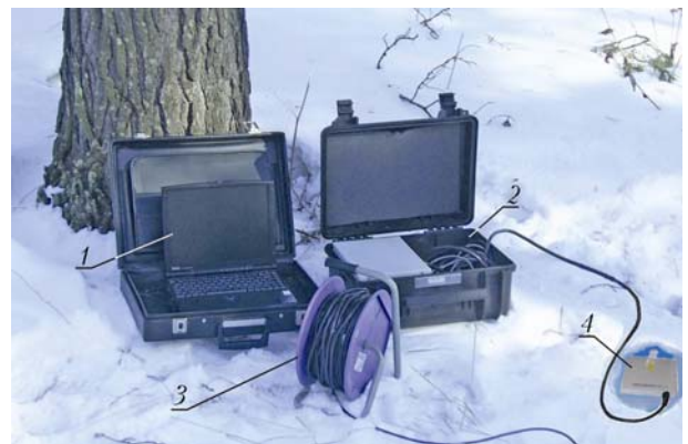
Рис. 4. Многоканальный регистратор МГР-01 на полевых испытаниях: 1 – ноутбук для записи результатов; 2 – укладочный ящик с блоком регистрации; 3 – катушка с кабелем электропитания; 4 – выносной антенный блок
