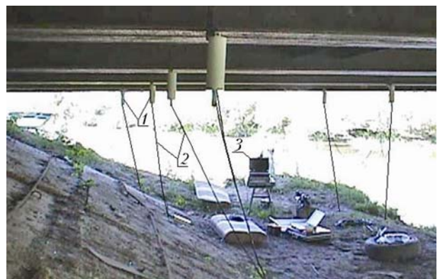
Рис. 5. Размещение системы «Фаза» под мостовым пролетом: 1 – акустические датчики; 2 – растяжки; 3 – ноутбук
