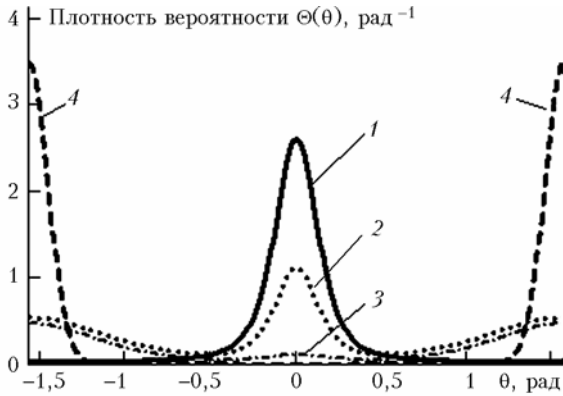
Рис. 2. Распределение осей вращения сплюснутых (2,5 : 1) сфероидов по полярному углу \theta при совместном действии аэродинамического и электростатического моментов сил. Напряженность электрического поля: 1 — E = 0 ; 2 — 4 \cdot 10^3 ; 3 — 10^4 ; 4 — 1,5 \cdot 10^4 В/м направлена вертикально ( \theta = 0 ). Распределение по размерам, принятое для расчета, представлено на рис. 3
