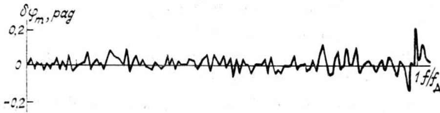
Рис. 2. Экспериментальный график ошибки оценки фазы \delta\varphi_m предложенным итерационным алгоритмом при 30-ти изображениях в зависимости от нормированной пространственной частоты f/f_d ( f_d – дифракционная частота)
