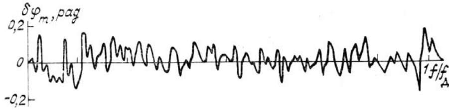
Рис. 1. Экспериментальный график ошибки \delta\varphi_m Фурье-спектра точечного источника по методу Вейгеля при 30-ти изображениях в зависимости от нормированной пространственной частоты f/f_d ( f_d – дифракционная частота)
