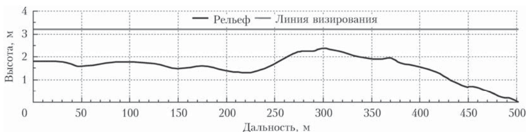
Рис. 4. Высотный профиль трассы на полигоне БЭК
