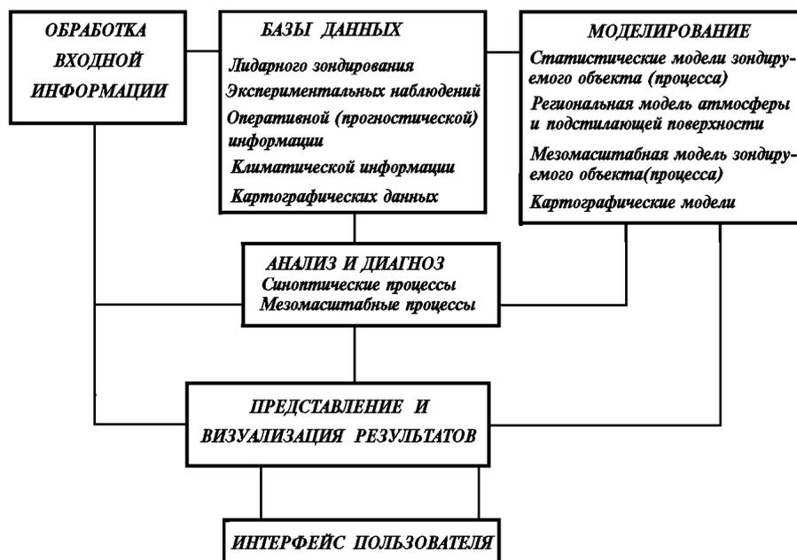
Рис. 3. Блок-схема локальной ГИС лазерного экологического мониторинга атмосферы
