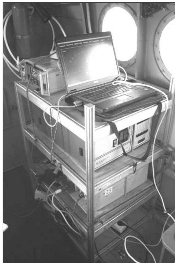
Рис. 2. Размещение приборной стойки внутри самолета Ан-2
