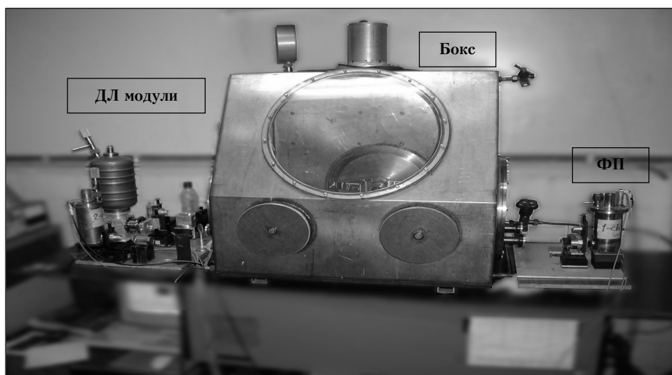
Рис. 2. Принципиальная блок-схема ДЛ спектрометра для изучения гидролиза гексафторида урана и измерения следовых количеств UF_6 и HF (а) и вид установки (б). Обозначения см. рис. 1. Fire Ware – шины передачи данных
